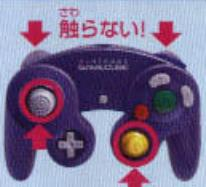
本体の電源をONにしたときの、これらのスティックやトリガーボタンの位置を「ニュートラルポジション」と呼びます。このときに各スティックが傾いていたり、各トリガーボタンが押されていた場合、その状態がニュートラルポジションと設定されてしまいます。このようにニュートラルポジションの位置がズレた状態では、正常な操作ができなくなります。
